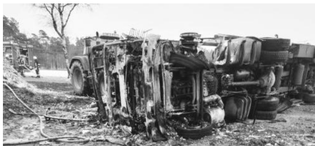
Auf dem Bild die Ausgebrannte Fahrerkabine des LKW:
