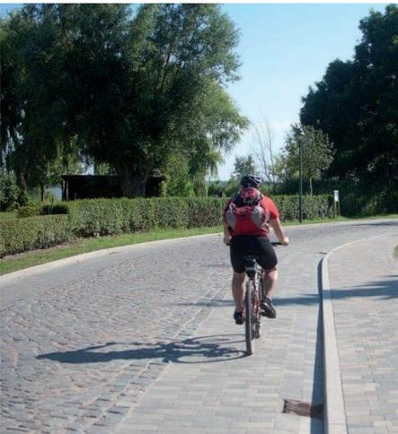
Abb. 15 Natursteinpflaster in Kombination mit Betonsteinpflaster
